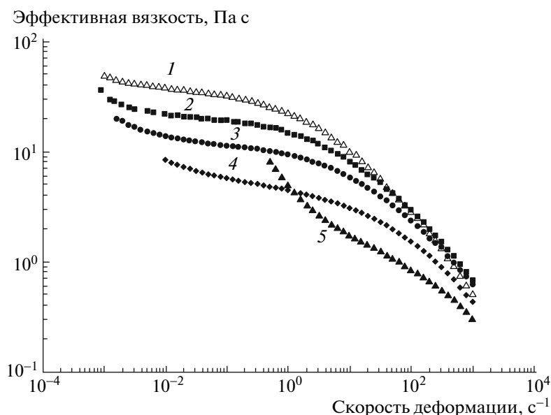
Рис. 4. Зависимости эффективной вязкости раствора хитозана от скорости сдвига при 10 (1), 20 (2), 30 (3), 50 (4) и 70 °С (5). Точки – экспериментальные данные, кривые – расчет.
